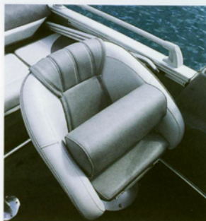
Die sehr bequemen vorderen Einzelstühle verfügen über nach oben klappbare Sitzflächen, so dass die Buster XL auch stehend manövriert werden kann. Ein absolut empfehlenswertes, weil komfortsteigerndes Extra sind die neuerdings lieferbaren Gasdruckdämpfer unter den Sitzen
