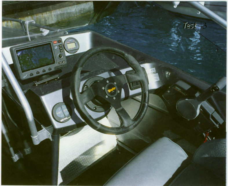
Die mechanische Lenkung arbeitet leichtgängig und ohne Spiel. Zwischen den Anschlagpunkten liegen etwas mehr als vier Ruderdrehungen
