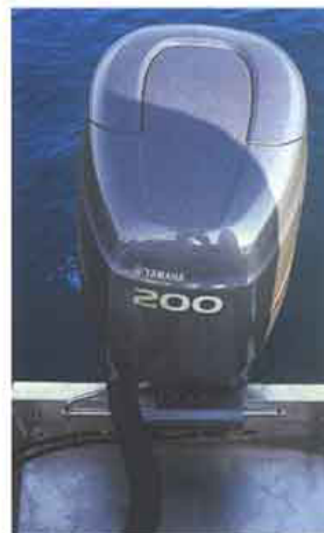
Kernige Zweitakt-Power aus Japan: Der bissig antretende Yamaha HPDI 200, ein V6-Motor mit 2596 cm 3 , mobilisiert 147 kW, die gleichzeitig die maximal zulässige Antriebsleistung für die Buster Magnum darstellen
