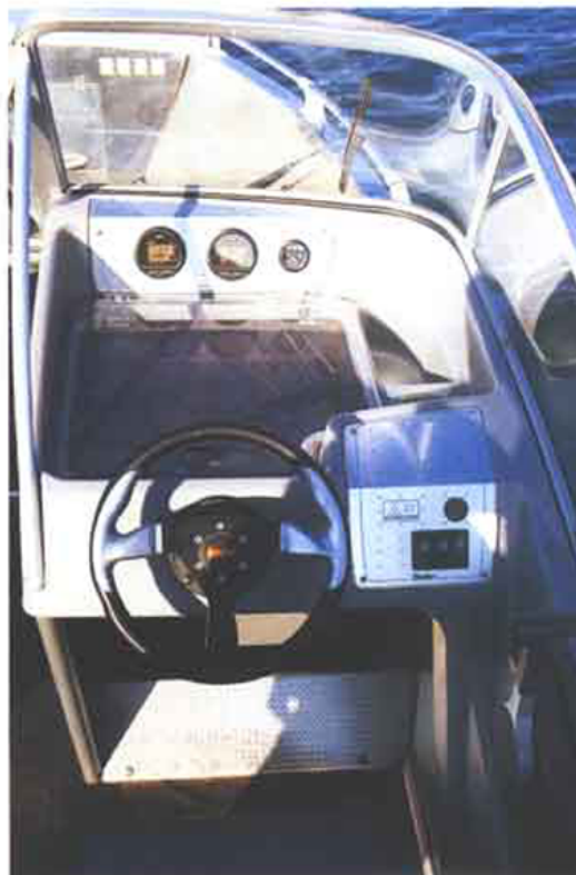
Das Armaturenbrett mit Kartenfach bietet ein rustikales, aber sehr übersichtliches Styling. Gut: Zur Grundausstattung des Bootes gehören drei 12-Volt-Steckdosen, eine Fußstütze und die sehr leichtgängige Hydrauliklenkung, die etwas indirekte fünfeinhalb Ruderdrehungen zwischen den Anschlagpunkten benötigt
