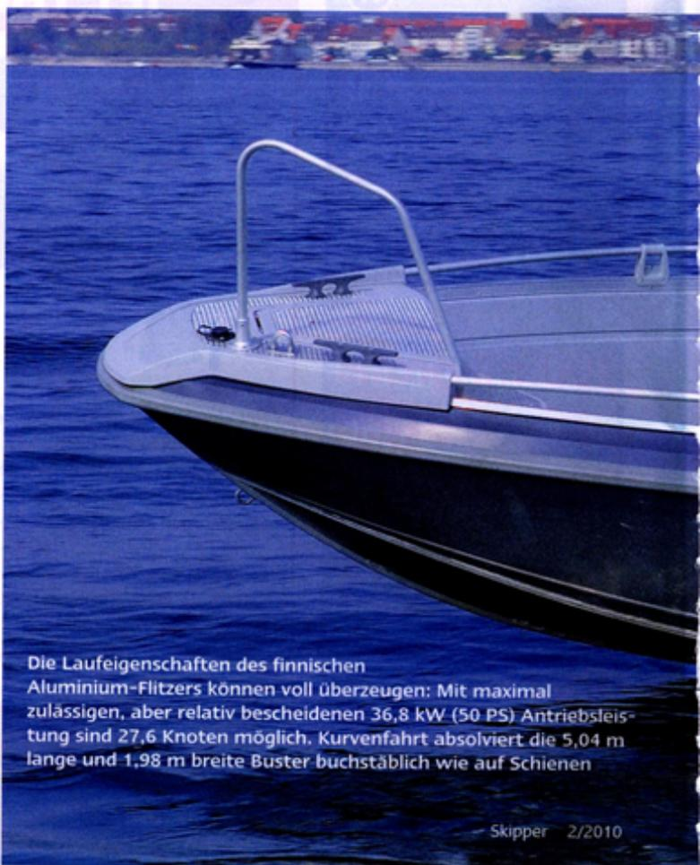
Die Laufeigenschaften des finnischen Aluminium-Flitzers können voll überzeugen: Mit maximal zulässigen, aber relativ bescheidenen 36,8 kW (50 PS) Antriebsleistung sind 27,6 Knoten möglich. Kurvenfahrt absolviert die 5,04 m lange und 1,98 m breite Buster buchstäblich wie auf Schienen
