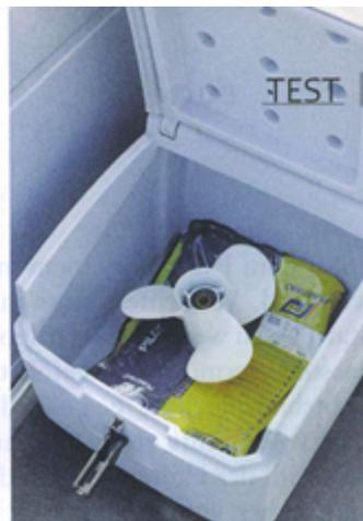
Praktisch: Die demontierbaren Sitzwürfel bestehen aus rotationsgegossenem Polyethylen
