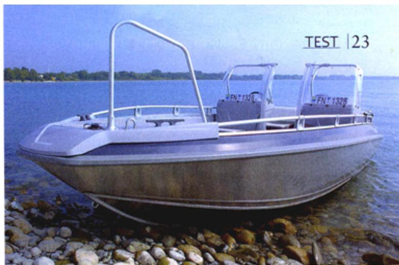
Hier hätte jedes GFK-Boot ein Problem: Der robust konstruierte Aluminium-Rumpf widersteht dem Kontakt mit steinigem Ufer
